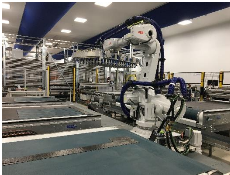
„Thinking Dezember“ Cutting & Stacking Zelle zum Schneiden und Stapeln von trockenen Fasern Bild: Schmidt & Heinzmann GmbH & Co. KG
